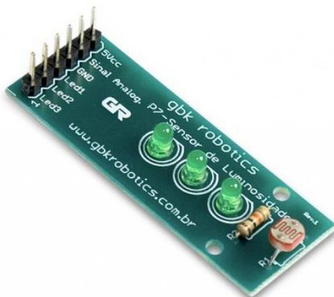
Este projeto pode ser montado substituindo os LEDs, os Resistores de 220 ohms (ou 330 ohms) e a Protoboard pelo módulo P7-Sensor de Luminosidade da GBK Robotics, neste caso:
